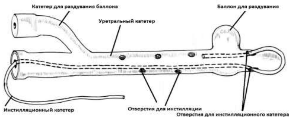
Рис. 8. Схематическое строение уретрального катетера.
