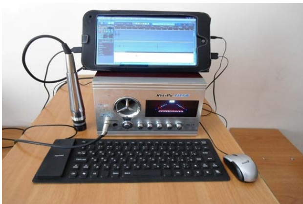
Рис. 1. Система, собранная для записи фоноэнтерографии.
