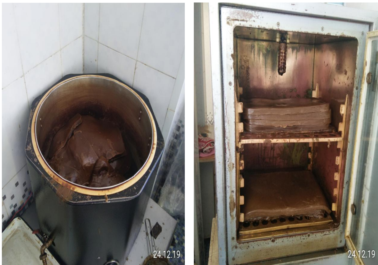
Рис. 2.4 Резервуары для разогревания (плавления) парафина
